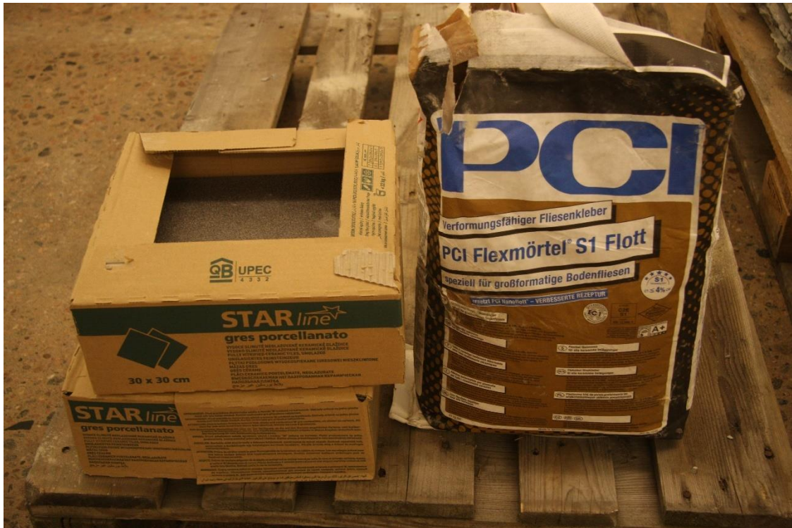
Bild 6 – Fästmassa och klinker.
