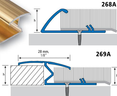
**ES EUROTRANSICIÓN,** Perfiles de aluminio destinados al remate final de moqueta, proporcionando un acabado perfecto y elegante. La sujeción de la moqueta se realiza mediante la fijación a los ganchos existentes en la base del perfil, y posterior tensión de la moqueta.
