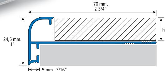
**ES EUROVIERTEAGUAS-242A**, perfil de aluminio de canto redondeado destinado a la protección de la cerámica en balcones o repisas exteriores. Colocado durante la obra proporciona el remate perfecto para evitar el goteo sobre la superficie vertical, evitando manchas antiestéticas en las paredes.
