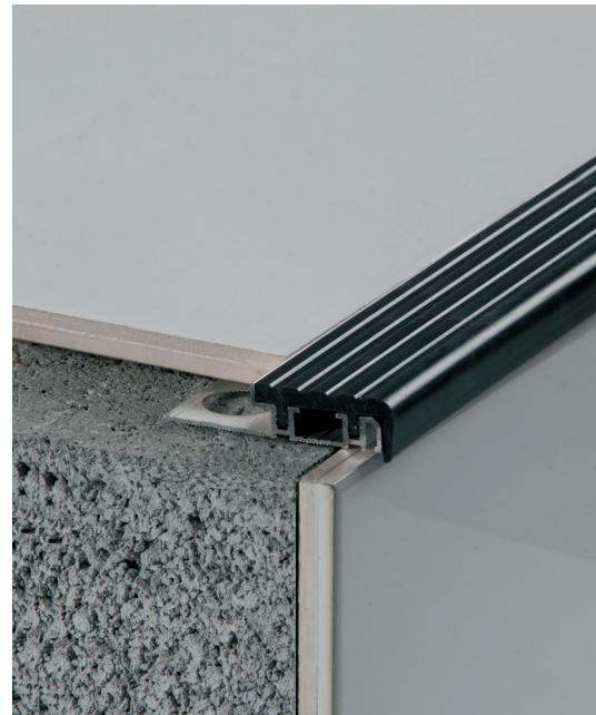
**ES EUROPELDAÑO-222A**, perfil de aluminio para escalones con una superficie de pisada de 31,5 mm, la parte de PVC, sustituible en caso de deterioro, proporciona una superficie antideslizante y de gran durabilidad en zonas de paso con mucho tránsito. El EUROPELDAÑO remarca el escalón dándole mayor visibilidad y protegiendo el canto del mismo, sea cuál sea el tipo de pavimento. Este perfil se ha de colocar durante el proceso de la obra.
