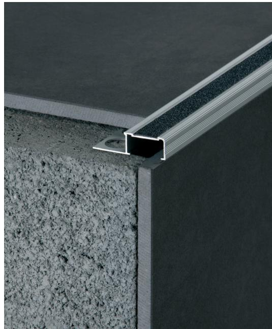
**ES** **EUROPELDAÑO-243A**, perfil de aluminio para escalones con una superficie de pisada de 26 mm. En la parte superior se ha insertado una tira antideslizante de gran dureza, por lo que es un perfil de gran utilidad en zonas con mucho tránsito. El Europeldaño proporciona una mayor seguridad junto con un mayor atractivo al escalón al hacerlo más visible. El EUROPEDANNO-243A se coloca durante el proceso de la obra y puede ser usado indistintamente en interiores o exteriores.
