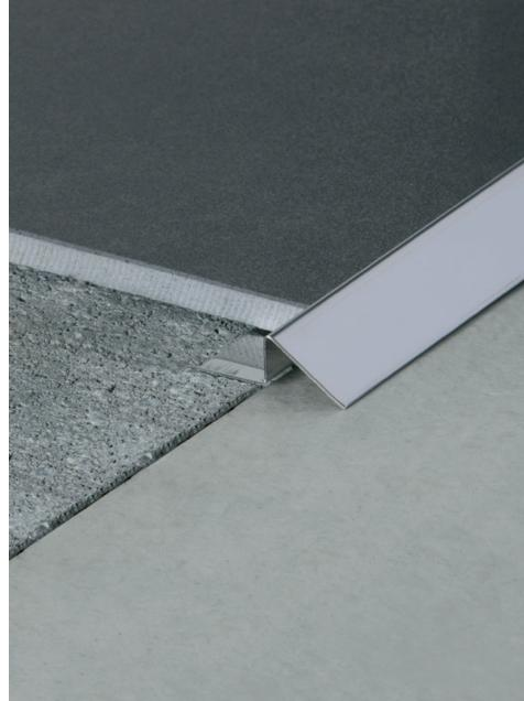
**ES EUROTRANSICIÓN-201S**, perfil de acero inoxidable diseñado para rematar la transición entre diferentes pavimentos. Permite vencer desniveles producidos entre diferentes materiales, como por ejemplo en las reformas al colocar un nuevo pavimento sobre el original. Apropiado para todo tipo de material como moqueta, parquet, cerámica, vinilo..., así como para zonas de mucho tránsito por su resistencia.
