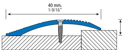
**ES** **EUROTRANSICIÓN-218A**, perfil de aluminio para transiciones entre pavimentos, que permite vencer desniveles desde 0 hasta 15 mm, permitiendo la transición entre cualquier tipo de pavimento.
