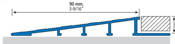
**ES EUROTRANSICIÓN-240A**, perfil de aluminio diseñado para rematar la transición entre diferentes pavimentos con desniveles. Debido a su amplia superficie de transición, 90 mm, puede ser usada en entradas a parkings, grandes almacenes o superficies para facilitar el tránsito rodado entre diferentes ambientes.
