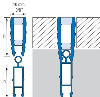
**ES** **EUROJUNTA-195**, perfil para juntas de dilatación, compuesto de PVC rígido con dos zonas centrales de PVC flexible que compensan los esfuerzos de presión. Está diseñado para poder adaptarse a las diferentes alturas del pavimento mediante un sistema de unión que le permite ensamblarse con la referencia **EUROJUNTA-196**. **EUROJUNTA-196**, perfil fabricado en PVC rígido y diseñado para poder unir varias piezas hasta lograr la altura deseada, en combinación con la **EUROJUNTA-195**.
