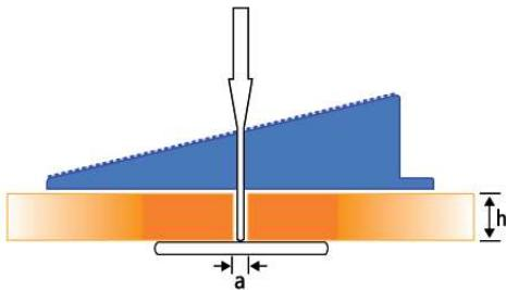
**ES** **EUROCUÑA AUTONIVELANTE**, Solución cuña autonivelante para la colocación de pavimento y revestimiento que proporciona automáticamente un nivelado perfecto. Proporciona juntas homogéneas, evita el movimiento de las baldosas durante el fraguado y optimiza el tiempo de colocación.
