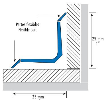
**ES EUROBAÑERA-154,** perfil de cierre flexible para el ensamblaje de revestimientos cerámicos con piezas de montaje que tengan contacto con el agua, como por ejemplo bañeras, platos de ducha, encimeras, etc. La EUROBAÑERA-154 se coloca con un cordón de silicona una vez finalizada la obra para prevenir la penetración del agua entre las dos superficies consiguiendo una impermeabilización total de la zona. Perfil de PVC de alta resistencia al paso del tiempo, fácil de colocar y de limpiar.
