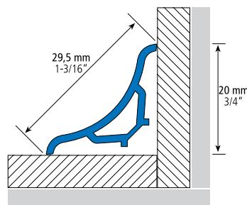
**ES** **EUROESCOCIA-211**, perfil de PVC utilizado para el ensamblaje del encuentro pared-suelo, así como para ángulos interiores entre paredes, uniones entre paredes y bañeras o platos de ducha, accesorios o superficies de baños y cocinas. Compensa los movimientos horizontales y verticales existentes entre la pared y el suelo. Este perfil cumple con las normativas de higiene y limpieza requeridas en la industria alimentaria, establecimientos sanitarios, ...
