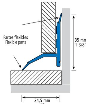
**ES EUROBAÑERA-114**, perfil de cierre flexible para el ensamblaje de revestimientos cerámicos con bañeras o platos de ducha, previniendo e impidiendo la penetración del agua entre estos y la pared. La EUROBAÑERA-114 se coloca durante el proceso de realización de la obra, por lo que garantiza la impermeabilización total de la zona. Perfil de PVC de alta resistencia al paso del tiempo y de fácil limpieza.
