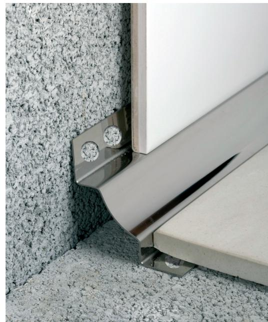
**ES EUROESCOCIA-210S**, perfil de Acero Inoxidable utilizado para el ensamble del encuentro pared-suelo. Compensa los movimientos horizontales y verticales existentes entre la pared y el suelo. Este perfil cumple con las normativas de higiene y limpieza requeridas en la industria alimentaria, establecimientos sanitarios, etc. La EUROESCOCIA-210S se ha de colocar durante el proceso de la obra.
