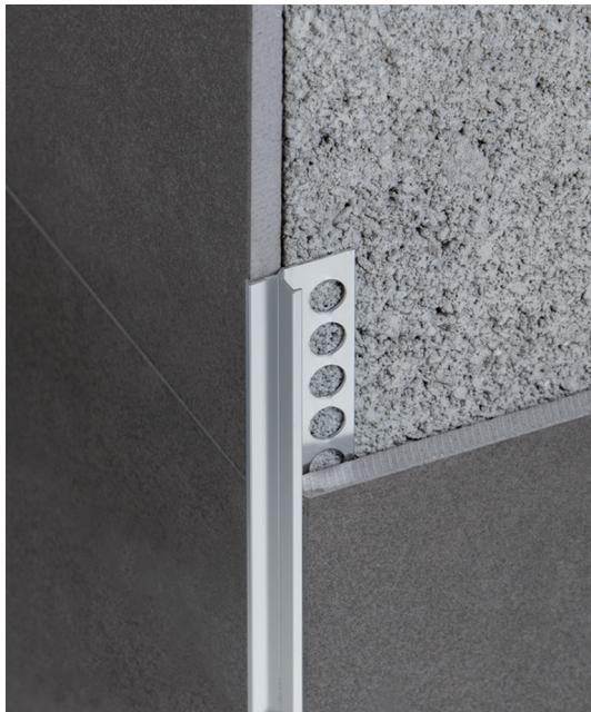
**ES** **EUROCANTO-150A**, Eurocanto de aluminio anodizado destinado a esquinas exteriores, así como al remate de ventanas y puertas, proporcionando un canto pilastra perfecto, en revestimientos cerámicos. Su principal función es proteger los cantos del azulejo de los deterioros debidos a esfuerzos mecánicos.
