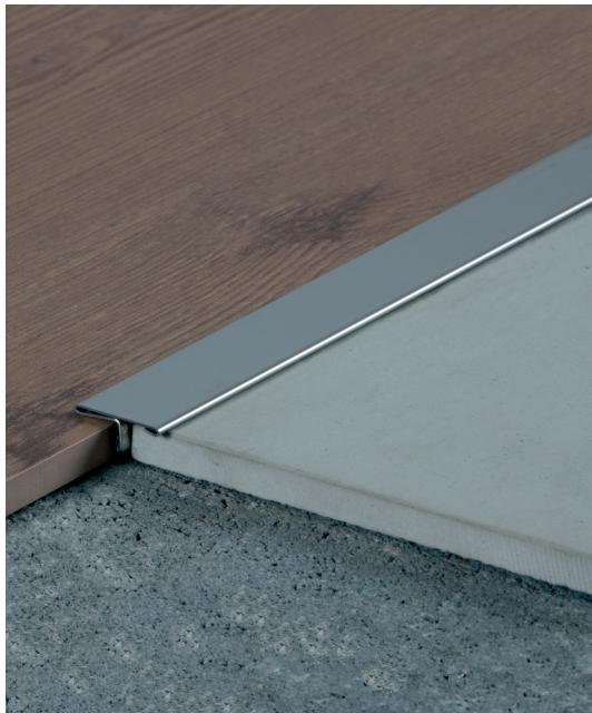
**ES EUROTRANSICIÓN-232S**, perfil de acero inoxidable en forma de T para transiciones entre pavimentos al mismo nivel o con desniveles mínimos. Se coloca entre ambos pavimentos con silicona que actua como junta de dilatación, pues absorbe los movimientos de los mismos, y proporciona protección a los cantos del pavimento, cerámica o parquet, que de otra manera quedarían desprotegidos completamente.
